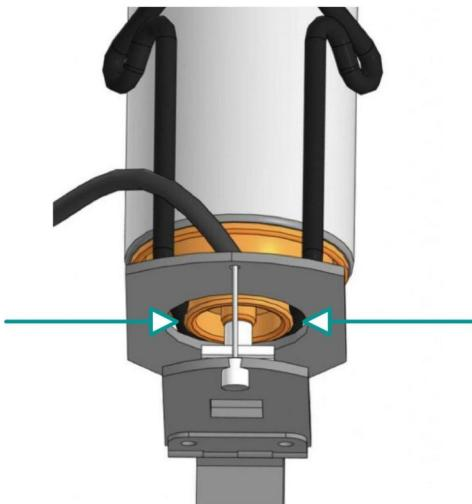
3. Распылительная головка должна быть по центру квадратного отверстия. Зафиксируйте баллон хомутом-липучкой:
