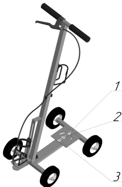
*Поверните заднюю часть тележки на заданный угол. Зафиксируйте винты 1 и 2.*
