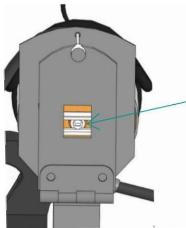
4. Для регулировки баллона по высоте ослабьте фиксирующие гайки:
